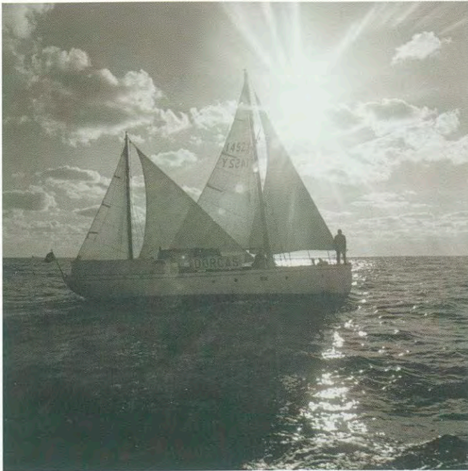
Mike und Hannelore Sparenborg mit „Dorcas“ Schiffstyp: Twin Screw Motor Sailor. Ketch gedakelt 550 sq.ft. Pitch Pine auf Oak. Baujahr 1934, ca. 13,00 m Werft: James Adam & Sons, Gourrock Scotland. 2 Vierzylinder BMC Commanders Diesel. 90 PS, 1500 rpm. Gezeichnet: W.E. McBryde
