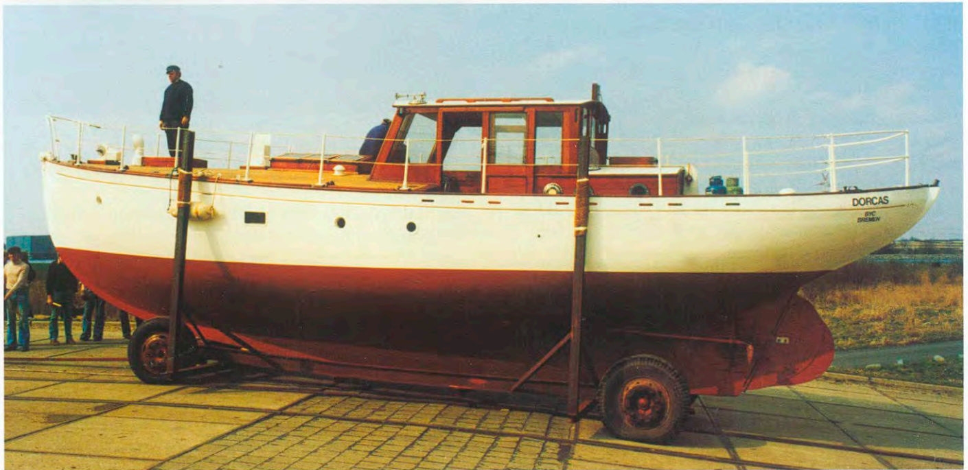
Mike und Hannelore Sparenborg mit „Dorcas“ Schiffstyp: Twin Screw Motor Sailor. Ketch gedakelt 550 sq.ft. Pitch Pine auf Oak. Baujahr 1934, ca. 13,00 m Werft: James Adam & Sons, Gourrock Scotland. 2 Vierzylinder BMC Commanders Diesel. 90 PS, 1500 rpm. Gezeichnet: W.E. McBryde
