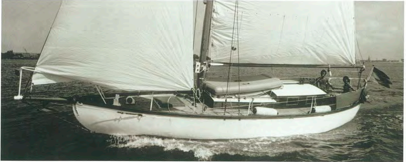
Bild oben „Nordwind“. Ein Langkielspitzgatter mit Kanuheck. Baujahr 1923, Deutsche Marinewerft Wilhelmshaven. 6 mm Schiffbaustahl genietet. Komplette Sanierung mit Innenausbau 1972 von Andreas und Sylvia von Engelbrechten.
